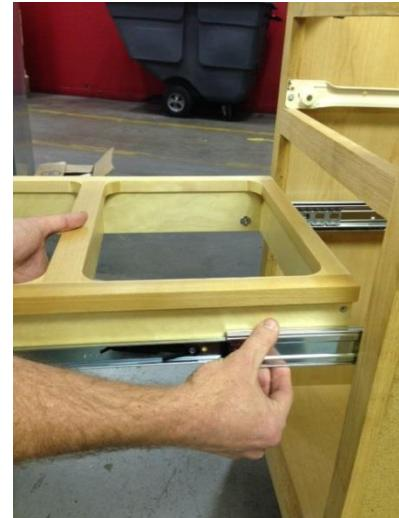
**Étape 6** Poussez avec précaution le cadre supérieur dans l'armoire. Il y aura une certaine résistance pour réinitialiser le mécanisme de fermeture en douceur. Tirez et poussez entièrement le cadre plusieurs fois pour assurer qu'il fonctionne correctement.
