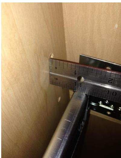
**ATENCIÓN** Mientras esté en el gabinete, mida la distancia que hay entre el muro del gabinete y la corredera. El receptáculo de montaje trasero está diseñado para flotar de izquierda derecha. En ocasiones, el receptáculo de montaje está apretado y es posible que necesite aplicar algo de fuerza para moverlo. Las correderas deben estar equidistantes a ambos lados.
