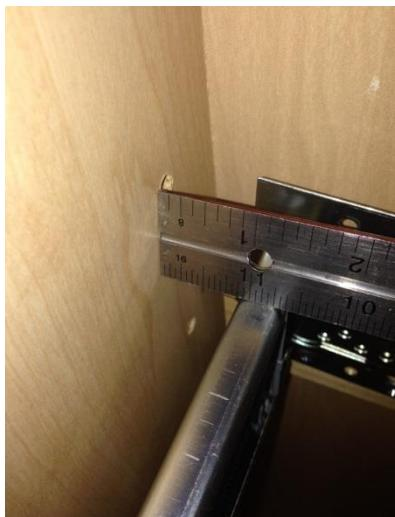
**CONSEIL** Pendant que vous êtes dans l'armoire, mesurez la distance entre la paroi de l'armoire et la glissière. La douille à montage arrière est conçue pour flotter de gauche à droite. Parfois la douille de montage est serrée et vous devrez probablement exercer un certain effort pour la faire bouger. Les glissières doivent équidistantes de chaque côté.
