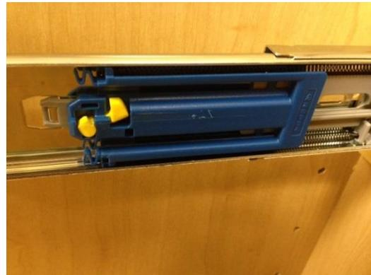
Si el producto no cierra correctamente, compruebe las correderas con un nivel. Asegúrese de que no tengan una inclinación cuesta abajo hacia fuera del gabinete. En ocasiones, será útil mover la parte delantera de las correderas hacia arriba, de modo que el marco de montaje superior corra ligeramente cuesta abajo hacia el interior del gabinete.
