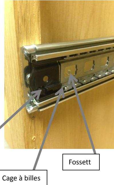
**Étape 4 NE PAS ESSAYER D'INSÉRER LES DEUX GLISSIÈRES EN MÊME TEMPS.** Tenez le cadre supérieur d'une main et tirez le membre intérieur de la glissière avec l'autre main. Assurez-vous que le membre du produit s'adapte correctement sur le roulement à billes
