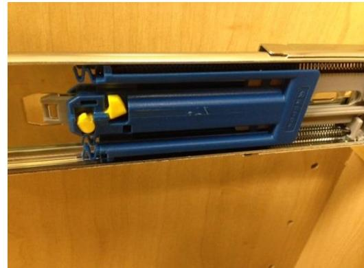
Si le produit ne ferme pas correctement, vérifiez les glissières à l'aide d'un niveau à bulle. Assurez-vous qu'elles ne sont pas inclinées vers le bas vers la sortie de l'armoire. Il pourra parfois s'avérer nécessaire de déplacer l'avant des glissières vers le haut de sorte que le cadre supérieur roule vers le bas vers l'intérieur de l'armoire.
